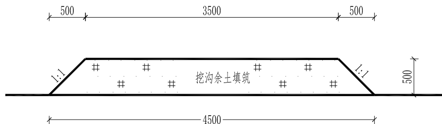
临时道路典型断面图 长度430m
